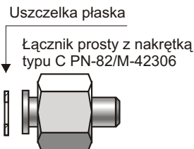
Przetwornik APR-2000ALW Wykonanie z króćcami typu P . Dopuszczalne ciśnienie statyczne 4 MPa
